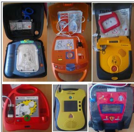
Abb. 2: Sechs der acht verwendeten PAD-Geräte (v.l.n.r.: Philips, Nihon Kohden, Physio Control (oben); Metrax, Defibtech, Schiller (unten)). Bereits auf den ersten Blick sind Unterschiede in der Gestaltung deutlich, auch hinsichtlich der Sprachanweisungen und Benutzerführung ergeben sich Abweichungen, deren Einfluss auf die Anwenderfreundlichkeit untersucht werden soll.
